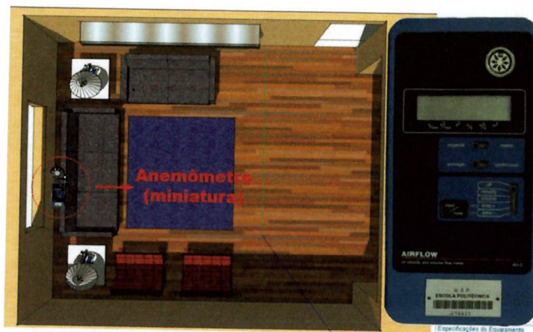
Figura 16. Ambiente da atividade de medição de velocidade e vazão de ar
